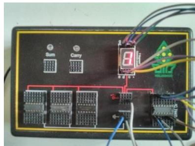
Gambar 16. Pengujian seven segment untuk input A=1 B=0 C=0 D=0
