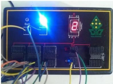
Gambar 13. Pengujian full adder untuk input A=0 B=1 C=1
